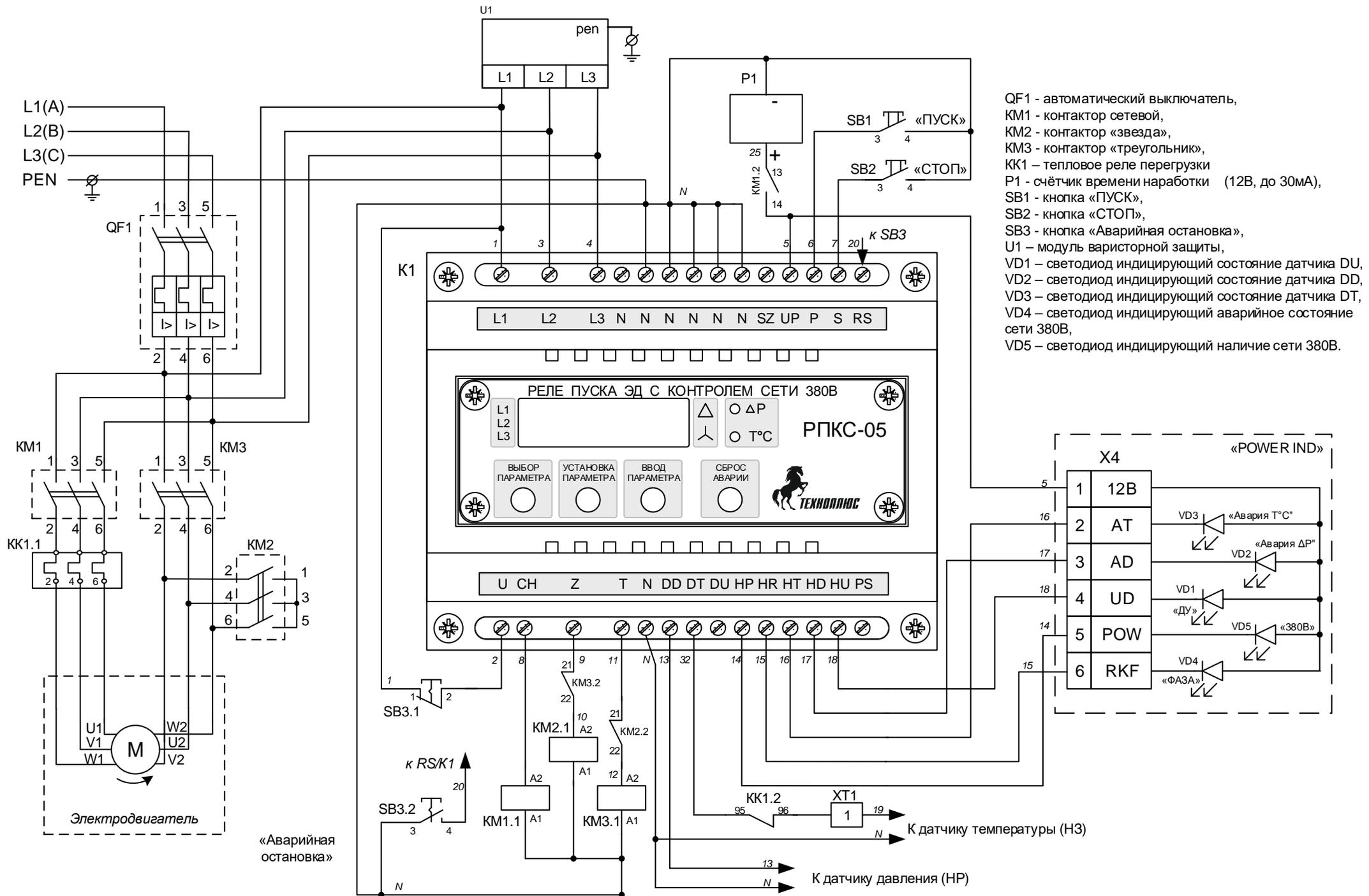
АРМ19-10(11,12,22)-05 схема электрическая принципиальная.
